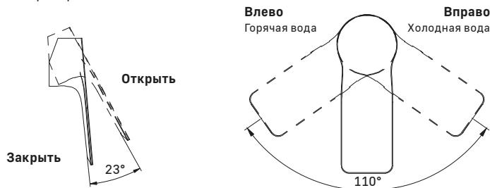
Смеситель оснащён картриджным переключателем и переключателем-дивертором с керамическими пластинаами, конструкция которых устойчива к гидроударам в момент переключения потока воды с душевой лейкой на излив, лейку верхнего душа и обратно.
